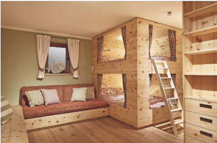
/ Das für die Einbauten im Gäste- und Kinderzimmer im Untergeschoss verwendete, unbehandelte Holz der Zirbelkiefer verbreitet einen angenehmen Geruch.
