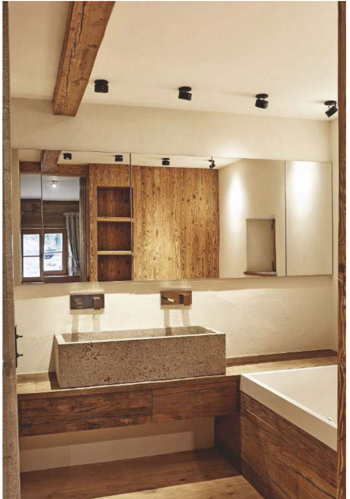
/ Individuelle Note: Für das Elternbad und anschließende WC in Eiche-Altholz wurden eigens trogartige Waschbecken aus Wachenzeller Dolomit von Hand gehauen.
