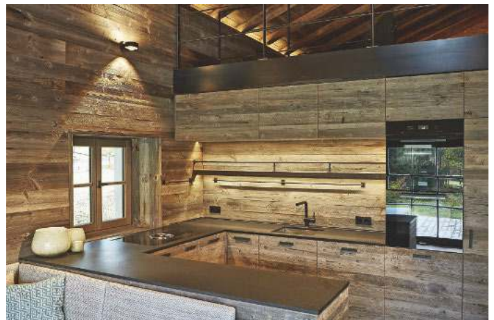
/ Die Kücheneinbauten aus silbergrau verwittertem Fichtenholz fügen sich unter die Galerie ein – dazu passend die Arbeitsplatte aus schwarzem, geflammtem Naturstein.
